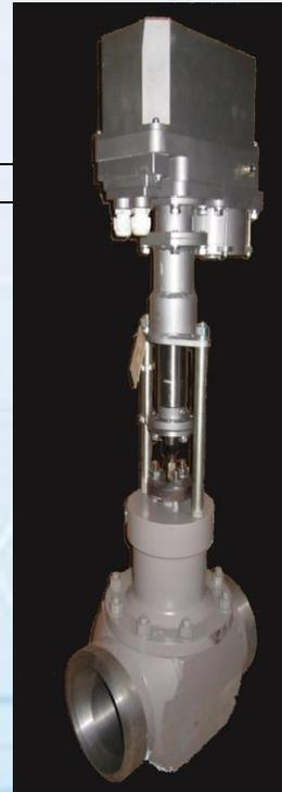
**Особенности конструкции:** клапан имеет сменные элементы проточной части, затвор клеточного типа с разгруженным плунжером, защитную сетку на клетке от попадания мех. частиц. Элементы проточной части имеют поверхностное упрочнение (карбонитрацию). Встроенный электропривод типа МЭП. Ремонт производится без демонтажа клапана из трубопровода путем замены затвора («клетка – плунжер», уплотнительные элементы). Расчётный срок эксплуатации – 200 тыс. часов.
