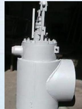
**Особенности конструкции:** клапан трёхпоточный со сменными элементами проточной части; уплотнения из терморасширенного графита. Привод типа МЭО, отдельно стоящий.
