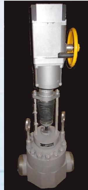
**Особенности конструкции:** клапан имеет сменные элементы проточной части, затвор клеточного типа с разгруженным плунжером (золотником), три ступени снижения давления. Встроенный электропривод типа МЭП. Ремонт производится без демонтажа клапана из трубопровода путем замены затвора («клетка – плунжер», уплотнительные элементы). Расчётный срок эксплуатации – 200 тыс. часов.
