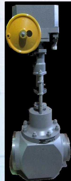
**Особенности конструкции:** клапан клетковый разгруженного типа, элементы проточной части – сменные, защитную сетку на клетке от попадания мех. частиц (грата). Ремонт производится без демонтажа клапана из трубопровода. Замена элементов проточной части (клетка–плунжер), производится на месте. Общий расчётный срок эксплуатации – 200 тыс. часов.
