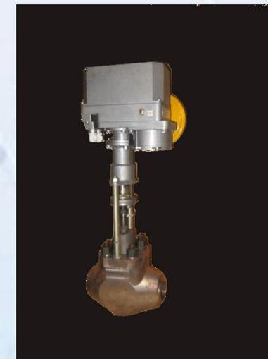
**Особенности конструкции:** сменные элементы проточной части, защита корпуса и выходного патрубка от размывания, не подвержен заклиниванию при попадании мех. частиц (грата), электропривод типа МЭП. Ремонт производится без демонтажа клапана из трубопровода путем замены элементов проточной части («клетка-плунжер», уплотнительные элементы),
