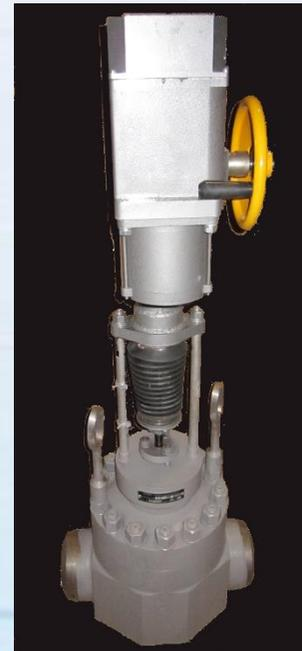
**Особенности конструкции:** клапан имеет сменные элементы проточной части, затвор клеточного типа с разгруженным плунжером (золотником). Встроенный электропривод типа МЭП. Ремонт производится без демонтажа клапана из трубопровода путем замены затвора («клетка – плунжер», уплотнительные элементы). Расчётный срок эксплуатации – 200 тыс. часов.
