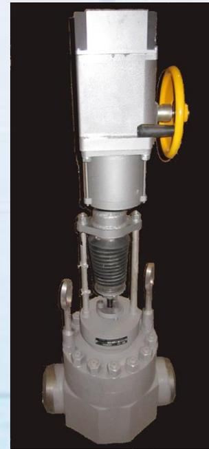
**Особенности конструкции:** клапан имеет сменные элементы проточной части, затвор клеточного типа с разгруженным плунжером (золотником), три ступени снижения давления. Встроенный электропривод типа МЭП. Ремонт производится без демонтажа клапана из трубопровода путем замены затвора («клетка – плунжер», уплотнительные элементы). Расчётный срок эксплуатации – 200 тыс. часов. Клапаны эксплуатируются на энергоблоках 200 МВт следующих ТЭС: Кураховской.
