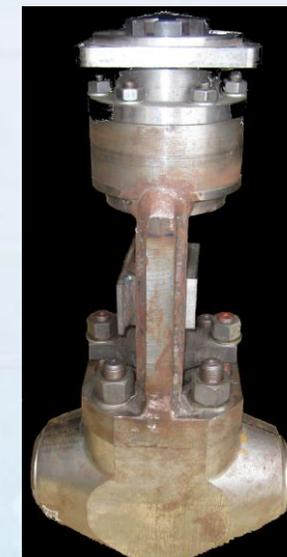
**Особенности конструкции:** клапан имеет сменные элементы проточной части. Ремонт производится без демонтажа клапана из трубопровода путем замены элементов проточной части. Расчётный срок эксплуатации – 200 тыс. часов.
