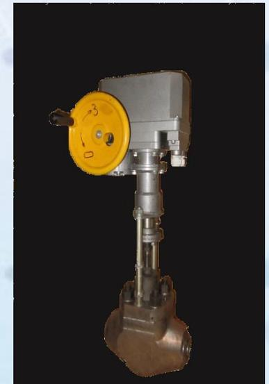
**Особенности конструкции:** клапан имеет сменные элементы проточной части, затвор клеточного типа с разгруженным плунжером (золотником). Встроенный электропривод типа МЭП. Ремонт производится без демонтажа клапана из трубопровода путем замены затвора («клетка – плунжер», уплотнительные элементы). Расчётный срок эксплуатации – 200 тыс. часов.
