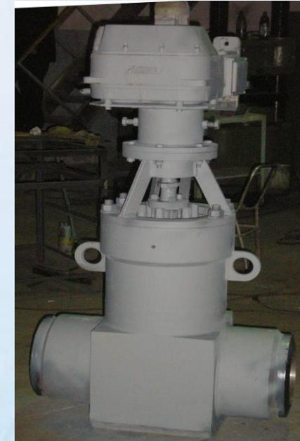
**Особенности конструкции:** клапан со сменными элементами проточной части, не подвержен заклиниванию при попадании мех. частиц (грата). Имеет устройство разгрузки прижима затвора к седлу, обеспечивающее равномерный крутящий момент во всем диапазоне регулирования (10 – 100%). Привод – встроенный. Ремонт производится без демонтажа клапана из трубопровода путем замены элементов проточной части (седло, затвор, сальник). Общий срок эксплуатации – не менее 200 тыс. часов.
