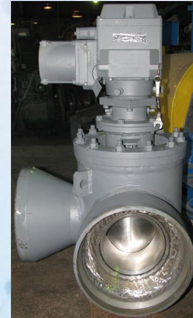
**Особенности конструкции:** клапан регулирующий со сменными элементами проточной части. Привод – встроенный. Ремонт производится без демонтажа клапана из трубопровода путем замены элементов проточной части (седло, затвор, сальник). Общий срок эксплуатации – не менее 200 тыс. часов.
