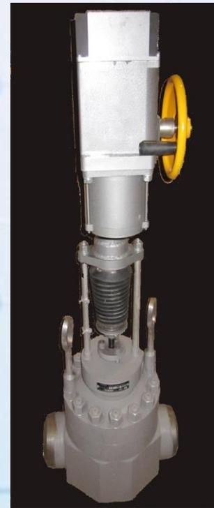
**Особенности конструкции:** клапан имеет сменные элементы проточной части, затвор клеточного типа с разгруженным плунжером (золотником), три ступени снижения давления. Встроенный электропривод типа МЭП. Ремонт производится без демонтажа клапана из трубопровода путем замены затвора («клетка – плунжер», уплотнительные элементы). Расчётный срок эксплуатации – 200 тыс. часов.
