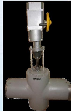
**Особенности конструкции:** трехпоточный клапан клеткового типа, элементы проточной части – сменные, защитную сетку на клетке от попадания мех. частиц (грата). Элементы проточной части имеют поверхностное упрочнение (карбонитрацию). Встроенный электропривод типа МЭП. Ремонт производится без демонтажа клапана из трубопровода путем замены затвора («клетка – плунжер», уплотнительные элементы). Расчётный срок эксплуатации – 200 тыс. часов.
