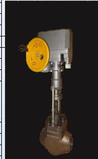
**Особенности конструкции:** клапан имеет сменные элементы проточной части, затвор клеточного типа с разгруженным плунжером, защитную сетку на клетке от попадания мех. частиц. Элементы проточной части имеют поверхностное упрочнение (карбонитрацию). Встроенный электропривод типа МЭП. Ремонт производится без демонтажа клапана из трубопровода путем замены затвора («клетка – плунжер», уплотнительные элементы). Расчётный срок эксплуатации – 200 тыс. часов.
